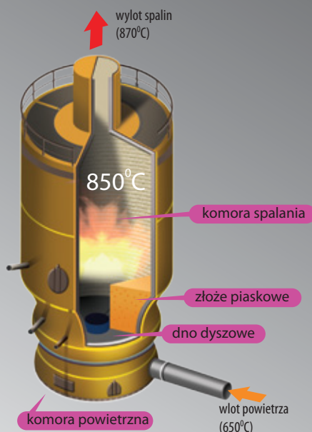
Przekrój pieca fluidalnego
